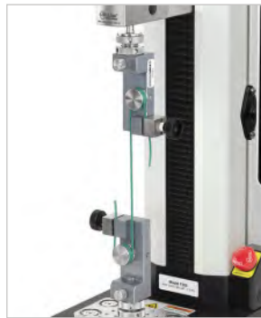
Wire tensile testing
